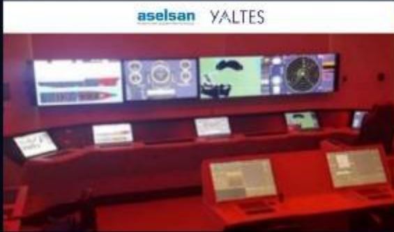
Köprü Üssü Kontrol Sistemleri
